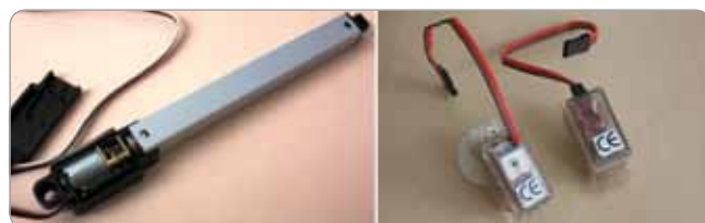
Obr. 35 Lineárny a rotačný polohový servomechanizmus
