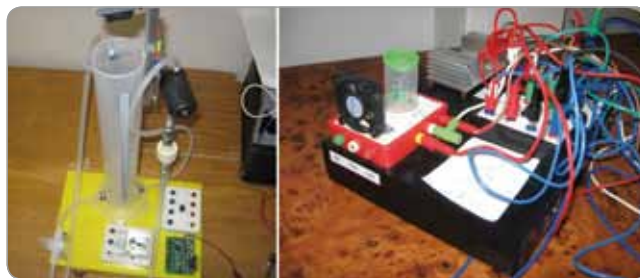
Obr. 40 Regulácia výšky vodnej hladiny a regulácia teploty v uzavretom priestore
